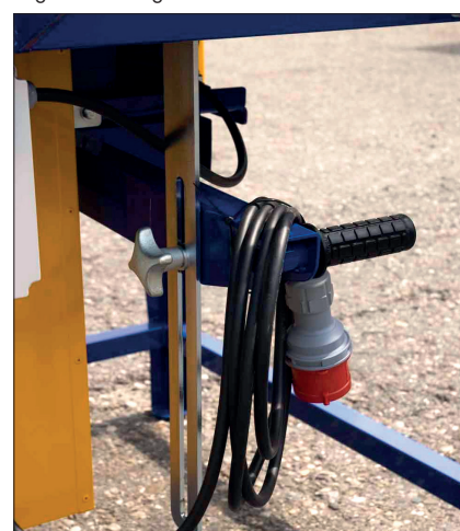
Réglage de la hauteur de la lame
