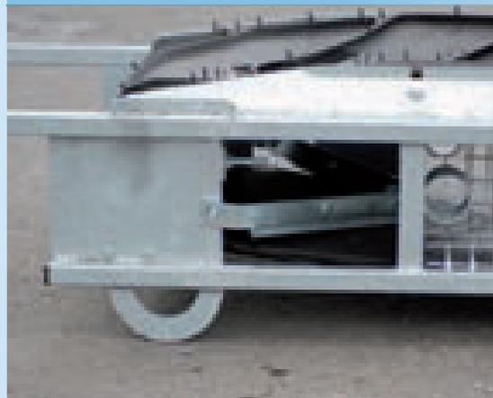
Un **simple racloir** maintient la bande parfaitement propre. Des ouvertures ont été prévues en vue du montage de tubes pour échafaudage. Réglage aisé de la bande.
