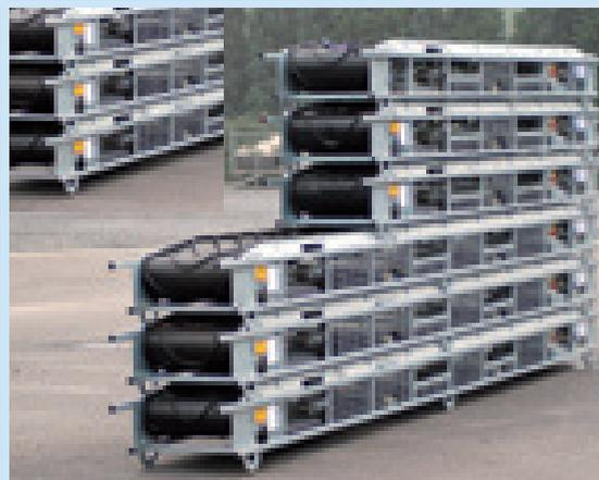
Grâce à leur **poids limité** et à leurs poignées fort pratiques, les convoyeurs à bande peuvent être déplacés par une seule personne. Les **évidements** permettent de les empiler rapidement et **en toute sécurité** à l'aide d'un chariot élévateur.
