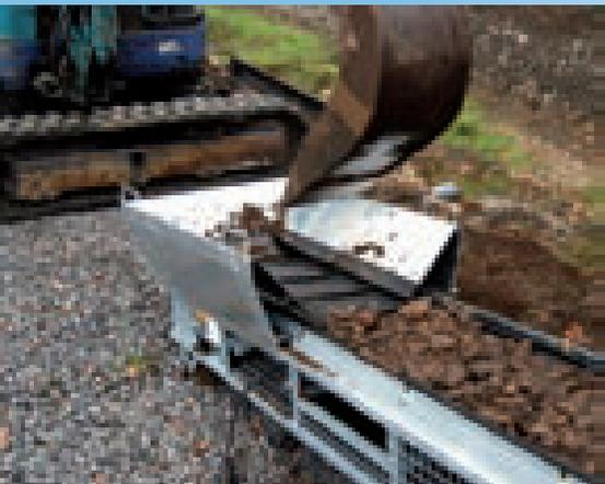
Nous avons prévu une **trémie plus large** pour le chargement à l'aide d'une mini-excavatrice.
